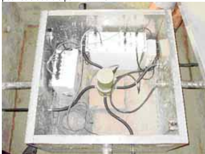
Figure 2 : Vue interne de la buse de I17H1 avec au centre le microbaromètre
